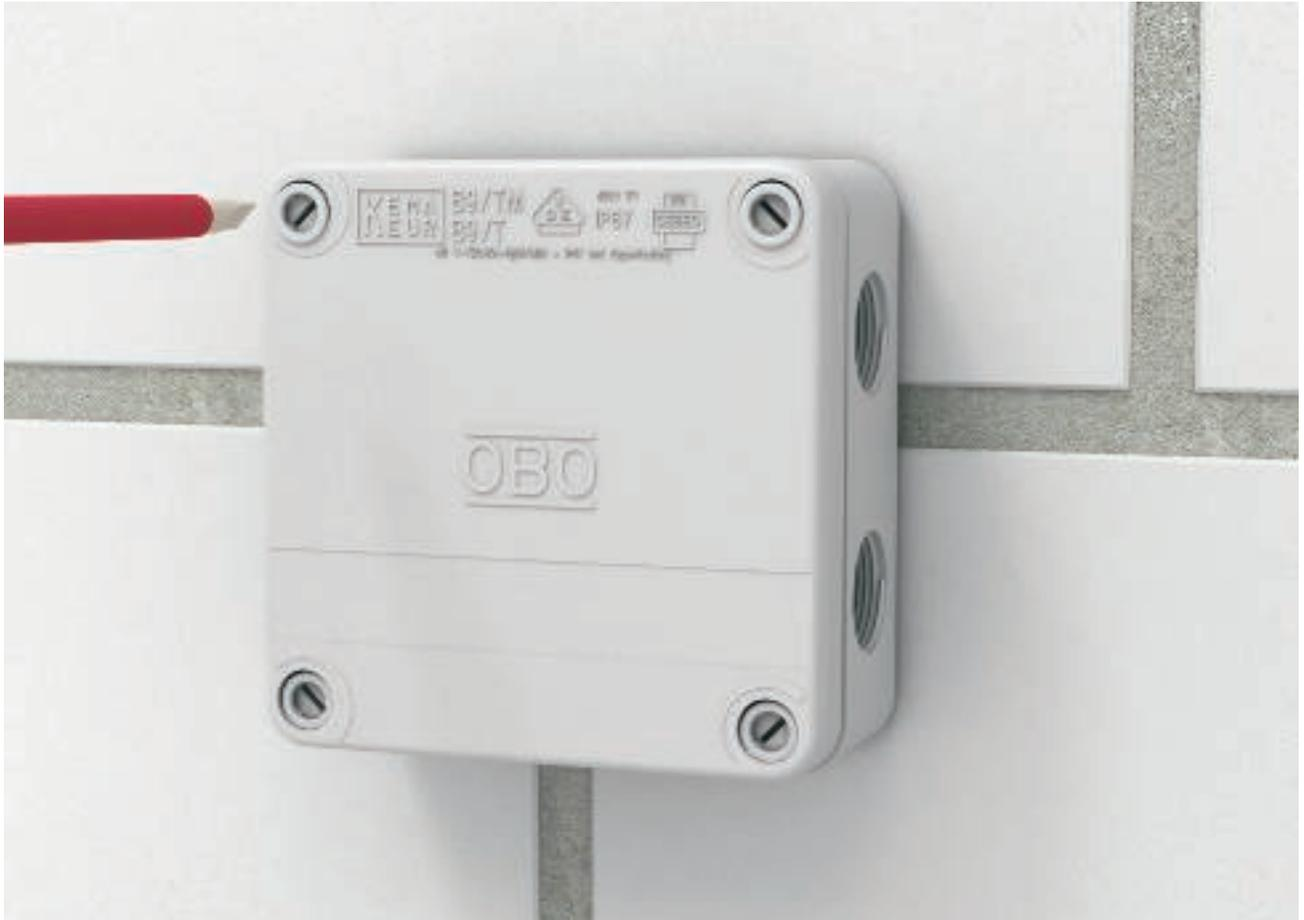
Der OBO B 9/T-Kabelabzweigkasten besteht aus zwei halogenfreien, thermoplastischen Kunststoffkomponenten: einer weichen für die Dichtung und einer harten für das Gehäuse. Diese 2K-Technik steht für perfekte Dichtigkeit und Stabilität. Die Schutzklasse IP67 wird sogar dann erreicht, wenn die Membran direkt mit Kabeln oder
