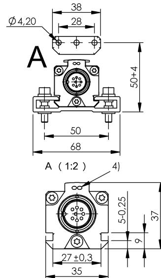
1) nicht im Lieferumfang, 2) nicht nutzbarer Bereich, 3) Nennlänge = Messlänge, 4) LED Funktionsanzeige, 10) Nullpunkt,
