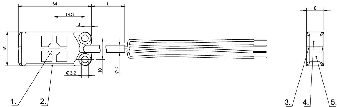
1) aktive Fläche, 2) Gehäuse, 3) Deckel, 4) Betriebsspannungsanz. grün, 5) Funktionsanzeige gelb
