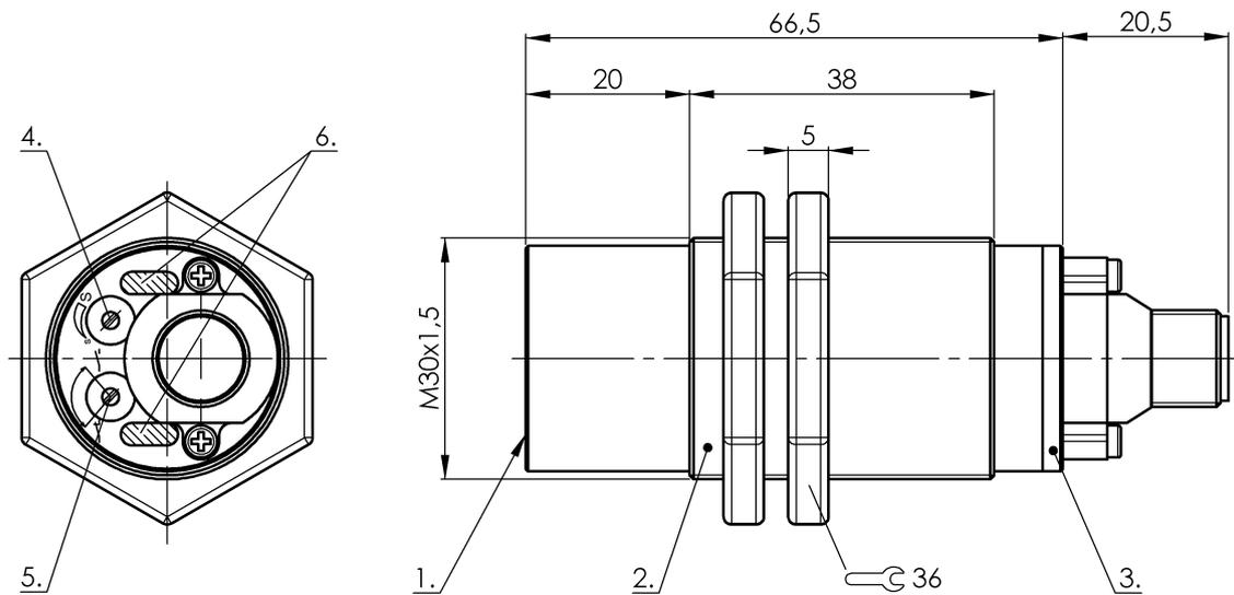
1) aktive Fläche, 2) Gehäuse, 3) Deckel, 4) Poti, 5) NO oder NC wählbar, 6) LED Funktionsanzeige
