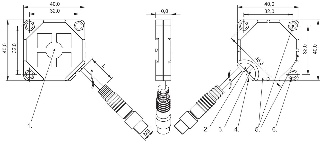
1) aktive Fläche 2) Betriebsspannungsanz. grün 3) Funktionsanzeige gelb 4) Poti 5) Befestigung: Kabelbinder 6) Befestigung: Schraube 3xM3
