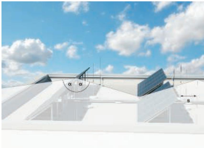
Bild 2:  $\alpha^\circ$  = Blitzschutzwinkel
