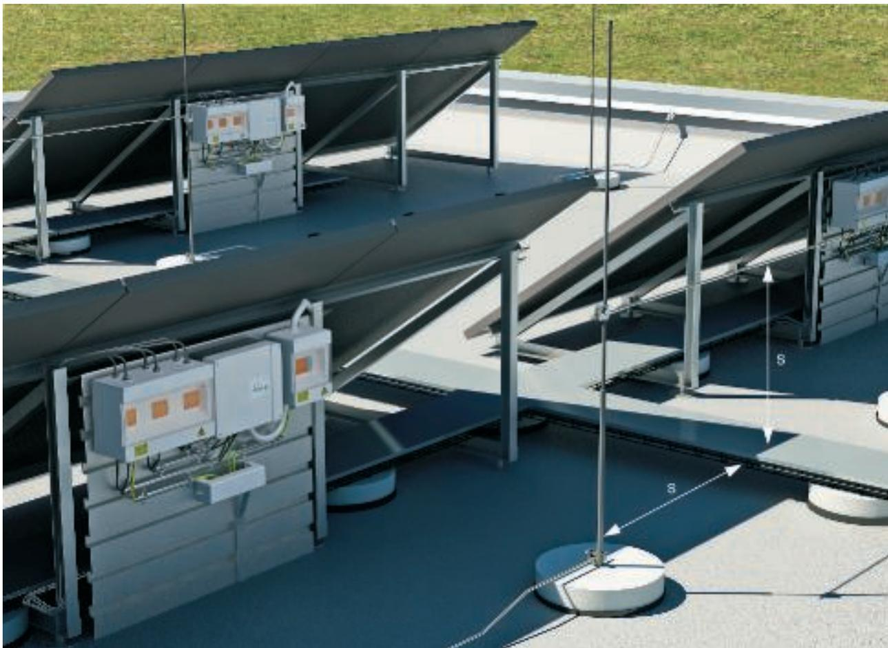
Bild 5: Trennungsabstand (s) zwischen Kabelkanal und Blitz-Fangeinrichtung
