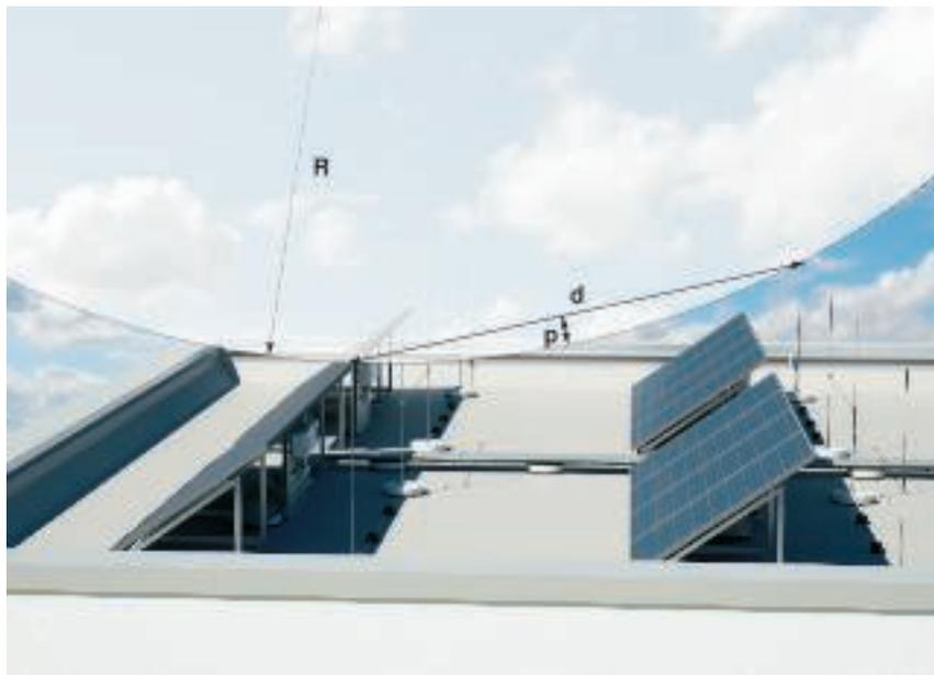
Bild 1: Planungsverfahren: Blitzkugel (R), Blitzkugelverfahren mit Eindringtiefe (p) und Abstand der Fangstangen (d)
