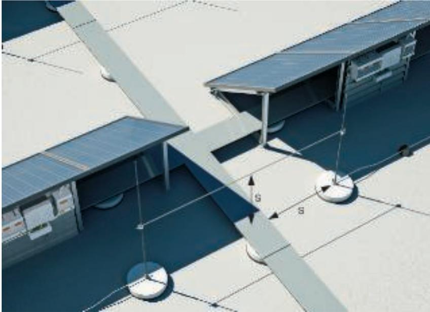
Bild 1: Trennungsabstand (s) zwischen Blitzschutzanlage und Kabeltragsystem
