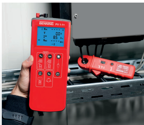
DC-Betriebsstrommessung mit BENNING CC 3
