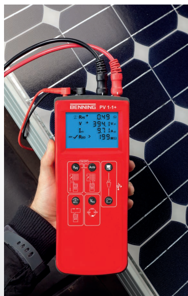
Automessung am PV-Strang ( U_{oc} , I_{sc} , R_{iso} )
