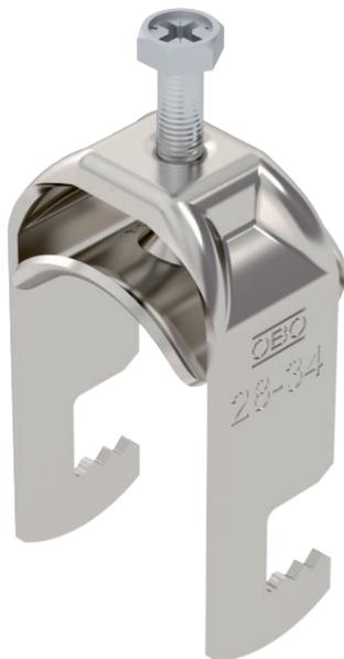
Bügelschelle mit F-Fuß, Metalldruckwanne mit gerundeten Kanten für Kabelschutz. Zur vertikalen und horizontalen Montage von 1 Einzelkabel an Flacheisen. Mit 1-gängiger Schraube an Druckwanne, universeller Sechskant-Schraubenkopf SW10, mit Schlitz und Kreuzschlitz. Geeignet für Montage im Innen- und Außenbereich. Der Einsatz einer Gegenwanne wird empfohlen.
