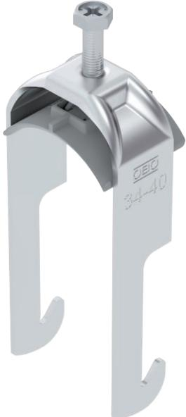
Bügelschelle mit W-Fuß, Kunststoffdruckwanne aus Polypropylen. Zur vertikalen und horizontalen Montage von 1 Einzelkabel an Winkelreisen bis < 40 mm. Mit 1-gängiger Schraube an Druckwanne, universeller Sechskant-Schraubenkopf SW10, mit Schlitz und Kreuzschlitz. Geeignet für Montage im Innen- und Außenbereich. Der Einsatz einer Gegenwanne wird empfohlen.
