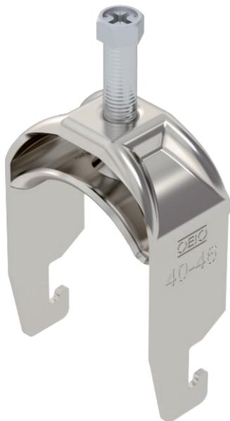
Bügelschelle mit U-Fuß, Metalldruckwanne mit gerundeten Kanten für Kabelschutz. Zur vertikalen und horizontalen Montage von 1 Einzelkabel an C-Profilsschiene. Für Schlitzweite 18 - 22 mm. Mit 1-gängiger Schraube an Druckwanne, universeller Sechskant-Schraubenkopf SW10, mit Schlitz und Kreuzschlitz. Geeignet für Montage im Innen- und Außenbereich. Der Einsatz einer Gegenwanne wird empfohlen.
