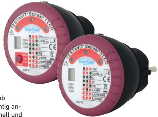
Mit den Testavit Schuki 1 LCD und 3 LCD prüft jedermann unkompliziert, ob Steckdosen, Kabeltrommeln oder Verbindungskabel in 230-V-Anlagen richtig angeschlossen sind. Dank dreier LEDs lässt sich der Anschlusszustand schnell und eindeutig bestimmen. Über den Fingerkontakt kann zudem getestet werden, ob am Schutzleiteranschluss eine unzulässig hohe Berührungsspannung anliegt. Mit dem Testavit Schuki 1 LCD kann zusätzlich ein 30 mA FI-Schutzschalter (RCD) ausgelöst werden.
