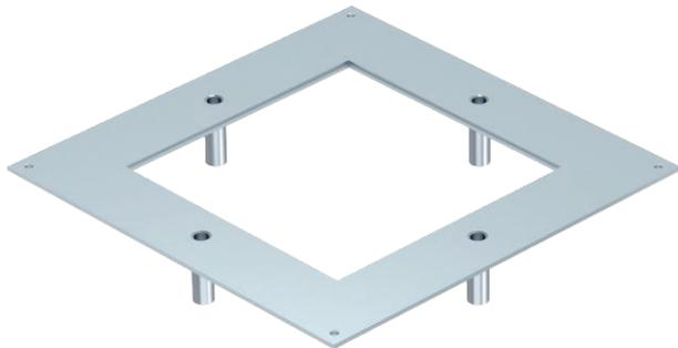
Der Schwerlast-Montagedeckel für die Unterflurdose vom Typ UZD350-3 eignet sich zum Einbau einer quadratischen Schwerlastkassette der Nenngröße 9. Die Einbauöffnung ist um 3 mm vertieft und kann dadurch nachträglich mit einer Deckelblindplatte verschlossen werden.
