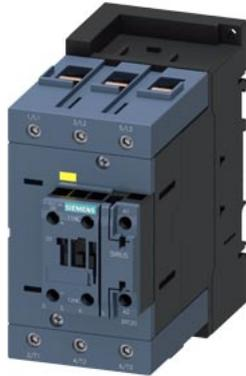
Schütz, AC-3, 110 A/400 V/60 °C S3, 3-polig, AC/DC 21-33 V, F-PLC-IN, mit Varistor, 1Ö, Schraubanschluss
