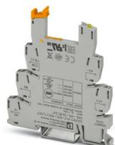
6,2 mm PLC-Grundklemme für Ausgabefunktionen mit Schraubanschluss, ohne Relais- oder Solid-State-Relaisbestückung, zur Montage auf Tragschiene NS 35/7,5, mit Lastrückleiteranschluss (BB), 1 Schließer, Eingangsspannung 24 V DC
