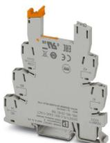
6,2 mm PLC-Grundklemme für Ausgabefunktionen mit Schraubanschluss, ohne Relais- oder Solid-State-Relaisbestückung, zur Montage auf Tragschiene NS 35/7,5, mit Lastrückleiteranschluss (BB), 1 Schließer, Eingangsspannung 24 V AC/DC
