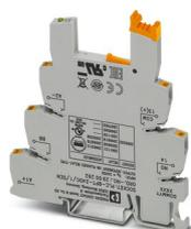
6,2 mm PLC-Grundklemme für Eingabefunktionen mit Push-in-Anschluss, ohne Relais- oder Solid-State-Relaisbestückung, zur Montage auf Tragschiene NS 35/7,5, mit Sensor-Versorgungsspannungsverteilung (BB), 1 Schließer, Eingangsspannung 24 V DC
