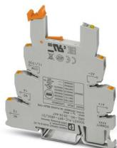
6,2 mm PLC-Grundklemme mit Push-in-Anschluss, ohne Relais- oder Solid-State-Relaisbestückung, zur Montage auf Tragschiene NS 35/7,5, 1 Wechsler, Eingangsspannung 48 V DC
