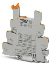
6,2 mm PLC-Grundklemme für Ausgabefunktionen mit Push-in-Anschluss, ohne Relais- oder Solid-State-Relaisbestückung, zur Montage auf Tragschiene NS 35/7,5, mit Lastrückleiteranschluss (BB), 1 Schließer, Eingangsspannung 24 V DC
