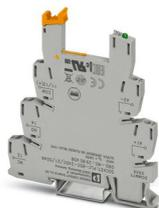
6,2 mm PLC-Grundklemme gegen Störströme beziehungsweise Störspannungen auf der Steuerseite mit Schraubanschluss, ohne Relais- oder Solid-State-Relaisbestückung, zur Montage auf Tragschiene NS 35/7,5, mit vergrößerter Eingangstromaufnahme, 1 Wechsler, Eingangsspannung 24 V DC
