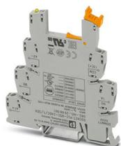
6,2 mm PLC-Grundklemme für Eingabefunktionen mit Schraubanschluss, ohne Relais- oder Solid-State-Relaisbestückung, zur Montage auf Tragschiene NS 35/7,5, mit Sensor-Versorgungsspannungsverteilung (BB), 1 Schließer, Eingangsspannung 24 V DC
