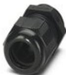
Kabelverschraubung, Material Verschraubung: PA, Kabelaußendurchmesser 10 mm ... 14 mm, Schirmung: nein, Anschlussgewinde: M20 x 1,5, Farbe: tiefschwarz RAL 9005
