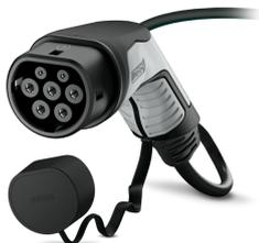
CHARX connect, AC-Ladeleitung mit Fahrzeug-Ladestecker und offenem Leitungsende, mit Schutzkappe, Gehäusefarbe schwarz-grau, zum Laden mit Wechselstrom (AC) von Elektrofahrzeugen (EV) mit Typ 2 Fahrzeug-Inlets, zur Installation an Ladestationen für die Elektromobilität (EVSE), Typ 2, IEC 62196-2, 32 A / 250 V (AC), C-Line, "PHOENIX CONTACT"-Logo, Kabel: 4 m, schwarz, gerade
