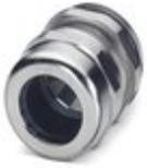
Kabelverschraubung, Material Verschraubung: Messing, vernickelt, Kabelaußendurchmesser 19 mm ... 27 mm, Schirmung: ja, Anschlussgewinde: M40 x 1,5, Farbe: silberfarben, mit O-Ring
