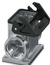
Sockelgehäuse B10, mit Längsbügel, Material: Aluminiumdruckguss, seewasserbeständig, Kabelabgänge: 2, seitlich, Höhe: 74,5 mm, Kabelverschraubung: ohne, Stutzen: nein, 2x M40, Standard
