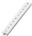
Marker für Klemmen, Streifen, weiß, beschriftet, beschriftbar mit: CMS-P1-PLOTTER, längs: L1, L2, L3, N, PE, L1, L2, L3, N, PE, Montageart: verrasten in hoher Schildchennut, für Klemmenbreite: 10,2 mm, Schriftfeldgröße: 10,15 x 10,5 mm, Anzahl der Einzelschilder: 10
