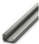
Tragschiene ungelocht, nach EN 60715, Material: Stahl, verzinkt, dickschichtpassiviert, G-Profil, Farbe: silberfarben
