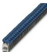
Anschlussklemme, Nennstrom: 76 A, Anschlussart: Schraubanschluss, Bemessungsquerschnitt: 16 mm<sup>2</sup>, Querschnitt: 1,5 mm<sup>2</sup> - 16 mm<sup>2</sup>, Montage: N-Sammelschiene, Farbe: blau
