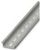
Tragschiene gelocht, nach EN 60715, Material: Stahl, verzinkt, dickschichtpassiviert, Standardprofil, Farbe: silber
