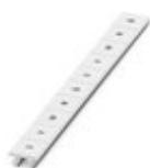
Marker für Klemmen, Streifen, weiß, beschriftet, beschriftbar mit: CMS-P1-PLOTTER, längs: U, V, W, N, GND, U, V, W, N, GND, Montageart: verrasten in hoher Schildchennut, für Klemmenbreite: 10,2 mm, Schriftfeldgröße: 10,15 x 10,5 mm, Anzahl der Einzelschilder: 10
