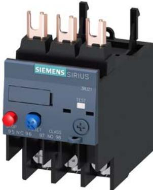
Überlastrelais 30...36 A thermisch für Motorschutz Baugröße S0, CLASS 10 Schützenbau Hauptstromkreis: Ringkabelschuh Hilfsstromkreis: Ringkabelschuh Hand-Automatik-RESET
