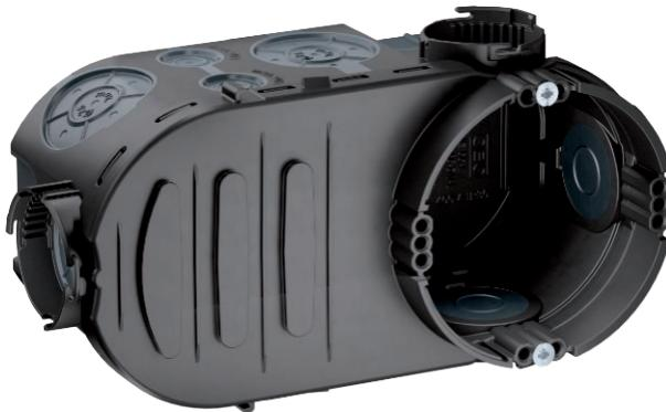
Unterputz-Elektronikdose mit zusätzlichem Klemmraum und luftdichten Membraneinführungen, für den Einsatz in Mauerwerk mit einer Einbautiefe von mindestens 66 mm.
