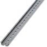
Tragschiene gelocht, Standardprofil, Breite: 35 mm, Höhe: 7,5 mm, nach EN 60715, Material: Stahl, verzinkt, weiß-passiviert, Länge: 2000 mm, Farbe: silberfarben
