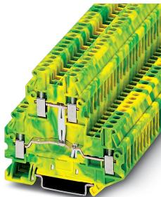
Schutzleiter-Doppelstockklemme, Anschlussart: Schraubanschluss, Anzahl der Anschlüsse: 4, Querschnitt: 0,14 mm<sup>2</sup> - 4 mm<sup>2</sup>, AWG: 26 - 12, Breite: 5,2 mm, Höhe: 64,4 mm, Farbe: grün-gelb, Montageart: NS 35/7,5, NS 35/15
