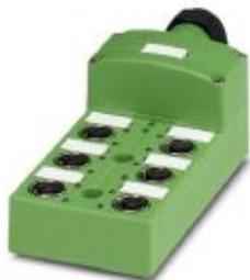
Sensor-/Aktor-Box, Anwendung: Standard, Anschlussart: M12-SPEEDCON-Buchse Metall, Anzahl der Steckplätze: 6, Polzahl: 5, Kodierung: A - Standard, Steckplatzbelegung: doppelt, Statusanzeige: Ja, pnp; Stammleitungsanschluss: Steckbarer Schraubanschluss 180°, Schirmung: nein
