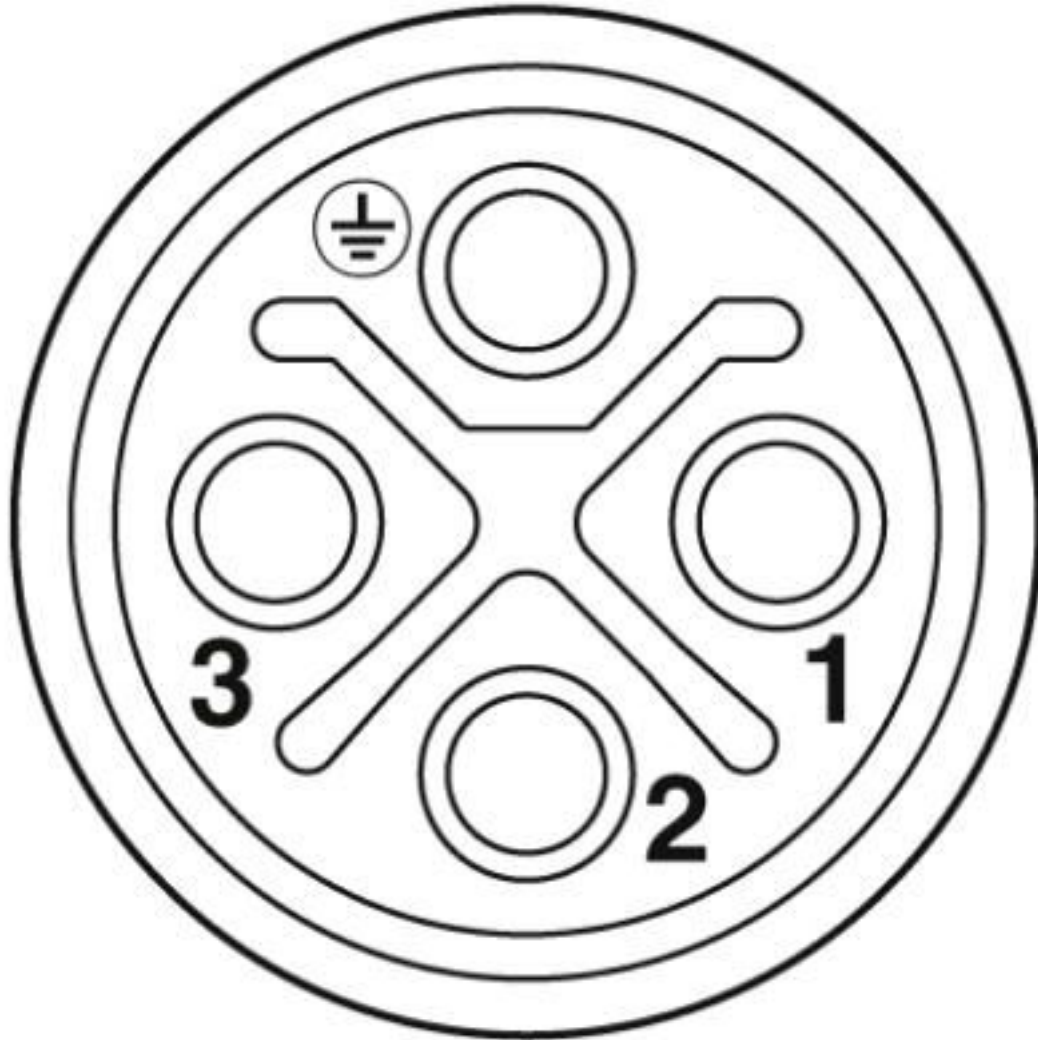
Polbild M12-Buchse, 4-polig, S-kodiert, Ansicht Buchsenseite
