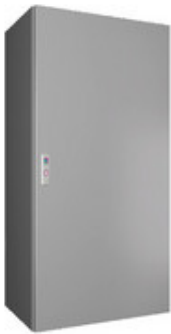
1261000 Kompakt-Schaltschrank AX, 1-türig, BHT 600x1200x400mm
