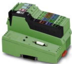
Inline, Buskoppler, PROFIBUS DP, D-SUB-9-Buchse, Digitale Eingänge: 8 , 24 V DC, Anschlusstechnik: 3-Leiter, Digitale Ausgänge: 4 , 24 V DC, 500 mA, Anschlusstechnik: 3-Leiter, Übertragungsgeschwindigkeit im Lokalbus: 500 kBit/s / 2 MBit/s, Schutzart: IP20, inklusive Inline-Steckern und Beschriftungsfeldern
