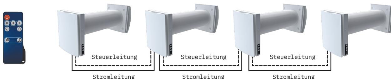
Die Lüftungsanlage ist mit einem Feuchtigkeitssensor für die Kontrolle der Raumluftfeuchtigkeit ausgestattet. Die Schaltung von mehreren Lüftungsanlagen gewährleistet eine kontrollierte Raumlüftung. Die erste Lüftungsanlage in der Reihe wird zum Mastergerät. Der Lüftungsbetrieb des ganzen Systems wird über das Bedienfeld des Mastergeräts gesteuert. Ein Signal aus der Fernbedienung wird nur vom Mastergerät empfangen.
