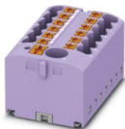
Verteilerblock, Grundklemme mit Einspeisung, Die Blöcke sind untereinander über den Leiterschacht brückbar. Passende Steckbrücken siehe Zubehör, Nennspannung: 450 V, Nennstrom: 24 A, Anschlussart: Push-in-Anschluss, Push-in-Anschluss, Anzahl der Anschlüsse: 13, Querschnitt: 0,14 mm<sup>2</sup> - 4 mm<sup>2</sup>, AWG: 26 - 12, Breite: 41 mm, Höhe: 22,7 mm, Farbe: violett, Montageart: kleben
