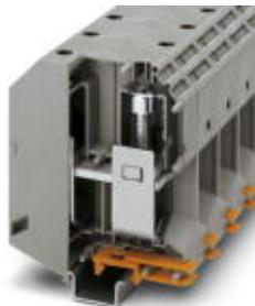
Hochstromklemme, Nennspannung: 1000 V, Nennstrom: 415 A, Anschlussart: Schraubanschluss, Anzahl der Anschlüsse: 2, Querschnitt: 70 mm<sup>2</sup> - 240 mm<sup>2</sup>, AWG: 2/0 - 500 kcmil, Breite: 36 mm, Höhe: 123,6 mm, Farbe: grau, Montageart: NS 35/15, NS 32
