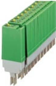
Relaisstecker, bestückt mit Kleinschaltrelais, Kontakte (AgPd60): kleine Leistungen, 1 Schließer, Eingangsspannung 230 V AC, mit Leuchtanzeige, steckbar auf Grundklemmenblöcke
