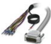
Konfektioniertes, geschirmtes Rundkabel; Anschluss 1: Einzeladern (15-polig) (Die Adern sind beschriftet und mit Aderendhülsen versehen. Das Schirmgeflecht ist auf ein separates Kabelende herausgeführt.); Anschluss 2: D-SUB-Stiftleiste (1x 15-polig); Kabellänge: 3 m
