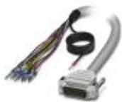
Konfektioniertes, geschirmtes Rundkabel; Anschluss 1: Einzeladern (15-polig) (Die Adern sind beschriftet und mit Aderendhülsen versehen. Das Schirmgeflecht ist auf ein separates Kabelende herausgeführt.); Anschluss 2: D-SUB-Stiftleiste (1x 15-polig); Kabellänge: 0,5 m
