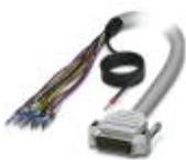
Konfektioniertes, geschirmtes Rundkabel; Anschluss 1: Einzeladern (15-polig) (Die Adern sind beschriftet und mit Aderendhülsen versehen. Das Schirmgeflecht ist auf ein separates Kabelende herausgeführt.); Anschluss 2: D-SUB-Stiftleiste (1x 15-polig); Kabellänge: 1 m
