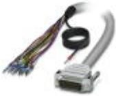
Konfektioniertes, geschirmtes Rundkabel; Anschluss 1: Einzeladern (15-polig) (Die Adern sind beschriftet und mit Aderendhülsen versehen. Das Schirmgeflecht ist auf ein separates Kabelende herausgeführt.); Anschluss 2: D-SUB-Stiftleiste (1x 15-polig); Kabellänge: 6 m
