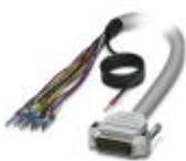
Konfektioniertes, geschirmtes Rundkabel; Anschluss 1: Einzeladern (15-polig) (Die Adern sind beschriftet und mit Aderendhülsen versehen. Das Schirmgeflecht ist auf ein separates Kabelende herausgeführt.); Anschluss 2: D-SUB-Stiftleiste (1x 15-polig); Kabellänge: 1,5 m
