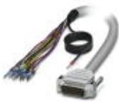
Konfektioniertes, geschirmtes Rundkabel; Anschluss 1: Einzeladern (15-polig) (Die Adern sind beschriftet und mit Aderendhülsen versehen. Das Schirmgeflecht ist auf ein separates Kabelende herausgeführt.); Anschluss 2: D-SUB-Stiftleiste (1x 15-polig); Kabellänge: 4 m
