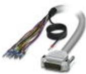
Konfektioniertes, geschirmtes Rundkabel; Anschluss 1: Einzeladern (15-polig) (Die Adern sind beschriftet und mit Aderendhülsen versehen. Das Schirmgeflecht ist auf ein separates Kabelende herausgeführt.); Anschluss 2: D-SUB-Stiftleiste (1x 15-polig); Kabellänge: 2 m
