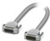
Konfektioniertes, geschirmtes Rundkabel; Anschluss 1: D-SUB-Buchsenleiste (1x 15-polig); Anschluss 2: D-SUB-Stiftleiste (1x 15-polig); Kabellänge: 1,5 m
