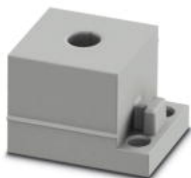
Kabeltülle, Anzahl der Leitungen: 1, Länge: 29,5 mm, Breite: 19,5 mm, Höhe: 17 mm, Leitungsaußendurchmesser: 1x 8 mm ... 9 mm , Farbe: grau
