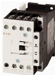
**Leistungsschütz, 4-polig, 32 A, 1 S, RDC 24: 24 - 27 V DC, Gleichstrombetätigung**
