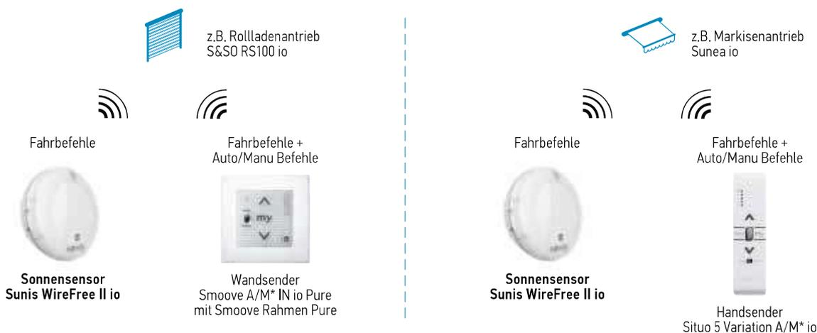
\*A/M Auto-Manu Schiebeschalter für Automatik EIN (Auto) oder Automatik AUS (Manu).
