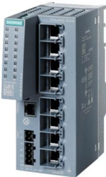
SCALANCE XC208 managbarer Layer 2 IE Switch; 8x 10/100 Mbit/s RJ45-Ports; 1x Konsolen-Port; Diagnose-LED; redundante Spannungsversorgung; Temp.-Bereich-40°C bis +70°C; Montage: Hut-/S7-Profilschiene/Wand Redundanzfunktionen Office Features (RSTP, VLAN,...); PROFINET IO-Device Ethernet/IP-konform C-PLUG Schacht;
