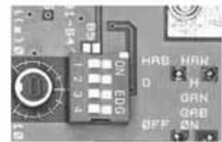
Mit den Potentiometer links neben den Schaltern können die Zeiten für GAN bzw. GAB stufenlos von 0,1 ... 10 s eingestellt werden.
