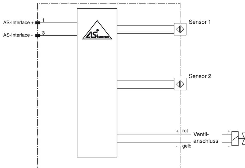
Der NCN3-F31-B3B-V1-K ist ein induktiver Doppelsensor dessen Anwendungsgebiet die Ventilstellungsrückmeldung von Schwenkantrieben ist. Dieser Doppelsensor wird mittels zweier Schrauben direkt auf dem Schwenkantrieb montiert. Zusätzliche Justierarbeiten sind nicht notwendig.
