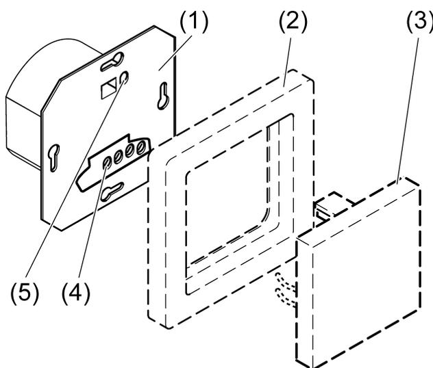
Bild 1: Geräteaufbau
