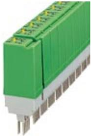
Relaisstecker, bestückt mit Kleinschaltrelais, Kontakte (AgNi): mittlere bis große Leistungen, 1 Wechsler, Eingangsspannung 230 V AC, mit Leuchtanzeige, steckbar auf Grundklemmenblöcke
