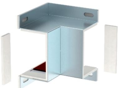
Formteil-Haube zur Abdeckung von zwei Kanalenden BSKM 0711 als Inneneck bei direkter Wand- und Deckenmontage. Inklusive eingeklebter Dichtungen zum Abdichten der Fugen und losen Dichtungen bei Kombination mit Gegenplatte, sowie Schrauben für den Potentialausgleich.
