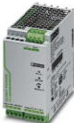
Primär getaktete Stromversorgung QUINT POWER zur Tragschienenmontage mit SFB (Selective Fuse Breaking) Technology, schutzlackiert, Eingang: 3-phasig, Ausgang: 24 V DC / 20 A
