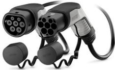
CHARX connect comfort, Typ 2, Mobile AC-Ladeleitung, 32 A dauerhaft, 480 V AC, mit Fahrzeug-Ladestecker und Infrastruktur-Ladestecker, Kabel: 5 m, schwarz, gerade, mit Schutzkappe, Gehäuse: schwarz, grau, PHOENIX CONTACT-Logo, IEC 62196-2, zum Laden mit Wechselstrom (AC) von Elektrofahrzeugen (EV) mit Typ 2 Fahrzeug-Ladedosen, Das farbliche Erscheinungsbild und der Glanzgrad des Ladekabels kann variieren.
