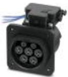
Infrastruktur-Ladedose zum Laden mit Wechselstrom (AC) von Elektrofahrzeugen, kompatibel zu Infrastruktur-Ladesteckern, Typ 2, IEC 62196-2, 32 A / 480 V (AC), 24 V Verriegelungsaktuator, Einzeladern, Länge: 0,7 m, Rückwandmontage, Verschraubung eines Klappdeckels: nur rückseitig möglich
