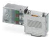
D-SUB-Stecker, 9-polig, Stift, Kabelzuführung unter 90°, Bussystem: PROFIBUS DP bis 12 MBit/s, Abschlusswiderstand über Schiebeschalter zuschaltbar, Pinbelegung: 3, 5, 6, 8; Schraubanschlussklemmen
