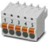
Steckerteil, Nennstrom: 8 A, Bemessungsspannung (III/2): 160 V, Polzahl: 5, Rastermaß: 3,81 mm, Anschlussart: Push-in-Federanschluss, Farbe: grau, Kontaktoberfläche: Zinn
