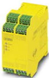
Sicherheitsrelais zur Not-Halt- und Schutztürüberwachung bis SIL 3 oder Kat. 4, PL e nach EN ISO 13849, ein- oder zweikanaliger Betrieb, 8 Freigabestrompfade,  $U_S = 24\text{ V AC/DC}$ , steckbare Schraubklemme
