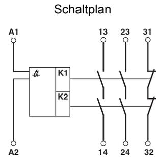
Beispiel einer galvanischen Trennung eines Sicherheits-SPS-Ausgangs vom Feld.
