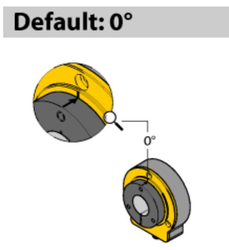
Umfangreiches Montagezubehör ermöglicht die einfache Anpassung an viele unterschiedliche Wellendurchmesser. Bedingt durch das Messprinzip, das auf einer Schwingkreis-Kopplung basiert, wird der Drehgeber nicht durch aufmagnetisierte Eisenteile oder sonstige Störfelder beeinflusst, so dass die Montage wenig Fehlerquellen bietet.
