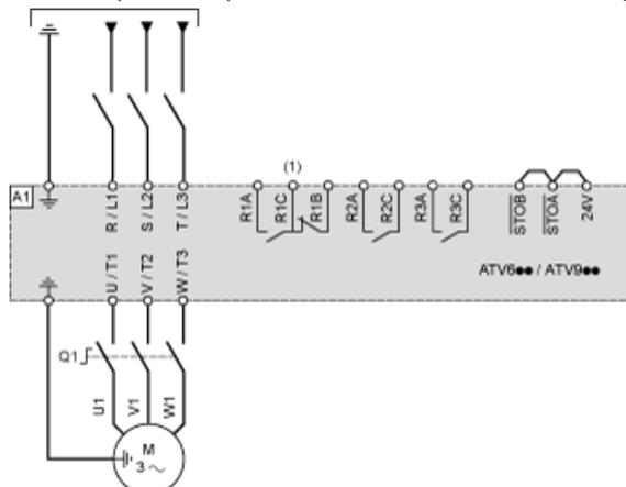
(1) Einstellung „Betriebszustand „Fehler“ des Digitalausgangs R1 zum Ausschalten des Produkts verwenden, wenn ein Fehler erkannt wird.
