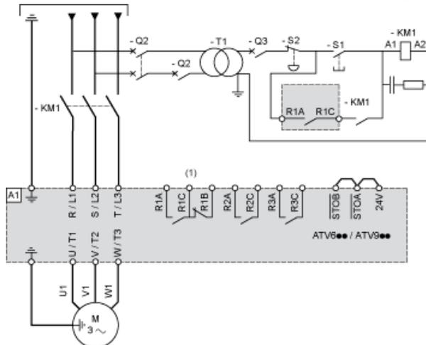
(1) Einstellung „Betriebszustand „Fehler“ des Digitalausgangs R1 zum Ausschalten des Produkts verwenden, wenn ein Fehler erkannt wird.
