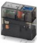
Steckbares Miniaturrelais, mit Mehrlagenkontakt mit Hartgoldauflage, 1 Wechsler, Prüftaste, mechanische Schaltstellungsanzeige, Status-LED, Freilaufdiode, Polarität A1+, A2-, Eingangsspannung 24 V DC
