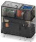
Steckbares Miniaturrelais, mit Leistungskontakt, 1 Wechsler, Prüftaste, mechanische Schaltstellungsanzeige, Status-LED, Freilaufdiode, Polarität A1+, A2-, Eingangsspannung 24 V DC
