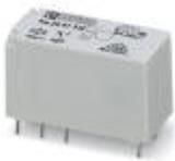
Steckbares Miniatur-Leistungsrelais, mit Mehrlagen-Goldkontakt für hohe Dauerströme, 1 Wechsler, Eingangsspannung 230 V AC
