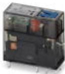
Steckbares Miniaturrelais, mit Mehrlagenkontakt mit Hartgoldauflage, 2 Wechsler, Prüftaste, mechanische Schaltstellungsanzeige, Status-LED, Freilaufdiode, Polarität A1+, A2-, Eingangsspannung 24 V DC
