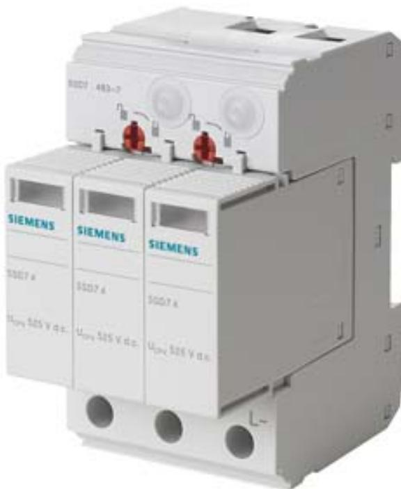
Überspannungsableiter T1/T2, UC 1050V DC,  $I_{max}$  40kA Kurzschlussfestigkeit 80A, 2+V Schaltung, für isolierte und geerdete PV-Systeme
