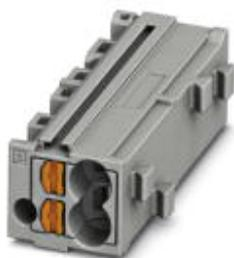
Rangierwabe, Nennspannung: 500 V, Nennstrom: 17,5 A, Querschnitt: 0,14 mm<sup>2</sup> - 2,5 mm<sup>2</sup>, AWG: 12 - 26, Anschlussart: Push-in-Anschluss, Polzahl: 1, Anzahl Anschlüsse: 4, Breite: 11 mm, Länge: 8,6 mm, Farbe: grau, Farbe Anschlusselemente: braun, Montage: aufrasten auf Tragschienenadapter, aufrasten auf Deckelflansch
