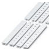
Zackband, Streifen, weiß, beschriftet, beschriftbar mit: Plotter, quer bedruckt: fortlaufende Zahlen 1-10, 11-20 usw. bis 991-1000, Montageart: Verrasten in hoher Schildchennut, für Klemmenbreite: 10,2 mm, Schriftfeldgröße: 10,15 x 10,5 mm
