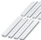
Marker für Klemmen, Streifen, weiß, beschriftet, beschriftbar mit: Plotter, längs: L1, L2, L3, N, PE, L1, L2, L3, N, PE, Montageart: Verrasten in hoher Schildchennut, für Klemmenbreite: 10,2 mm, Schriftfeldgröße: 10,15 x 10,5 mm
